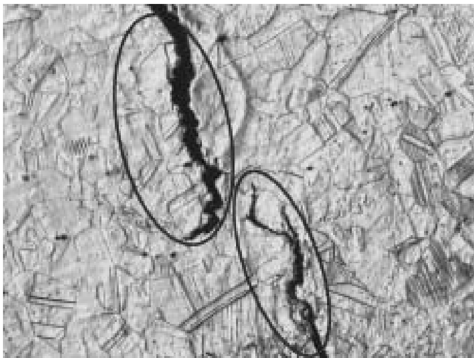
(c)显微组织发现裂纹已扩展到检材内部 (注:以上"***X"表示图片的放大倍率为"***倍")
